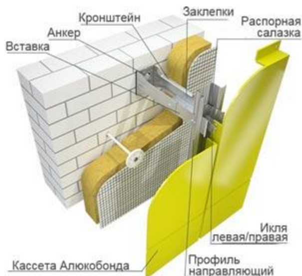
Рисунок 4 – Схема монтажа «Распорных салазок»
