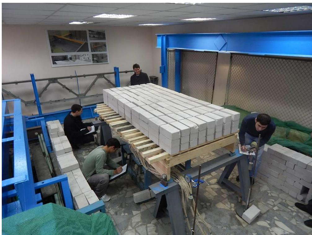
Рисунок 5 – Снятие отсчетов с регистрирующих приборов. Третья ступень
