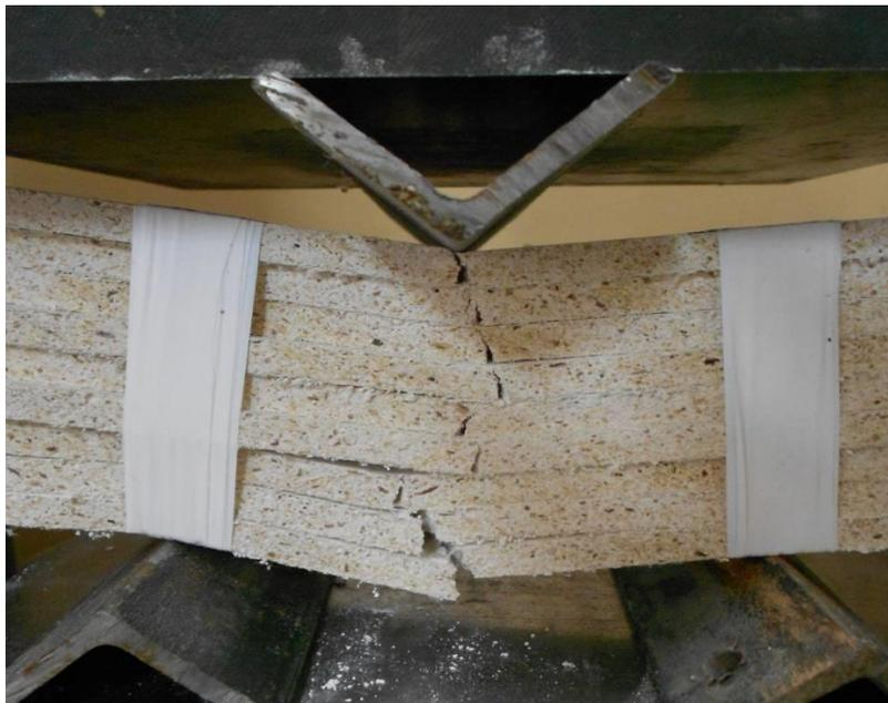
Рисунок 4 - Определение предела прочности при изгибе образцов
