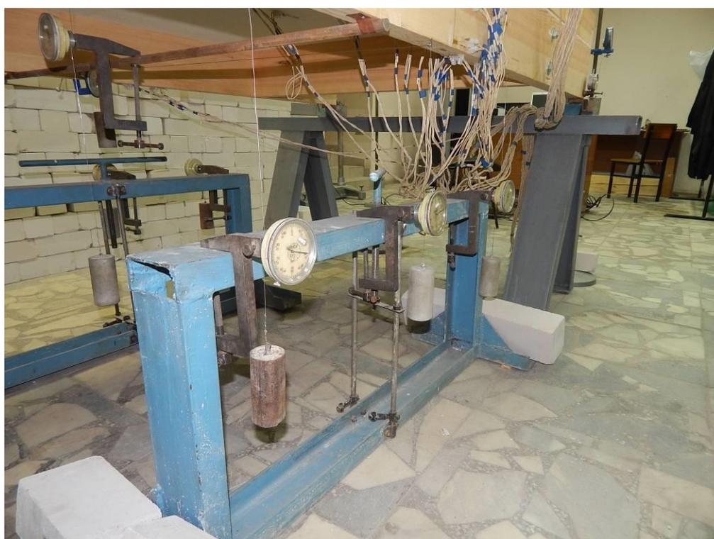
Рисунок 2 - Прогибомеры, установленные в середине и третях пролета
