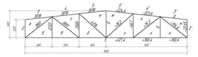
Рисунок 3 – Геометрическая схема фермы (длины указаны в мм, усилия в кH)
