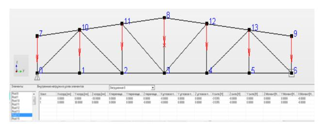
Рисунок 2 — Расчетная схема фермы при построении в программном комплексе
