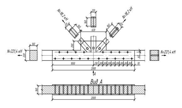
Рисунок 4 – Центральный укрупнительный узел нижнего пояса фермы
