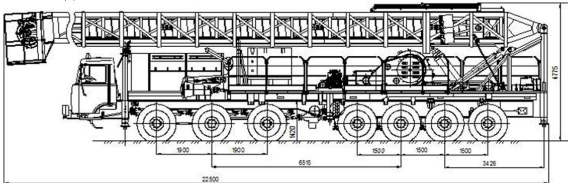
Рисунок 1 - Схема установка МБУ 160
