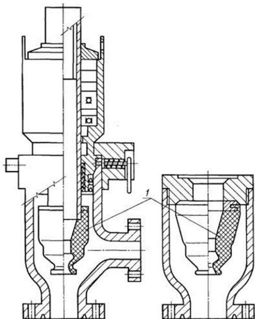
Рисунок 2 - Роторный устьевый герметизатор
