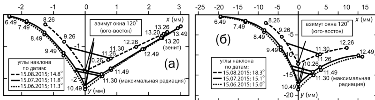
Рисунок 2. Оптимальные углы наклона решеток фильтра по датам для одинарных (а) и двойных (б) остекленных окон
