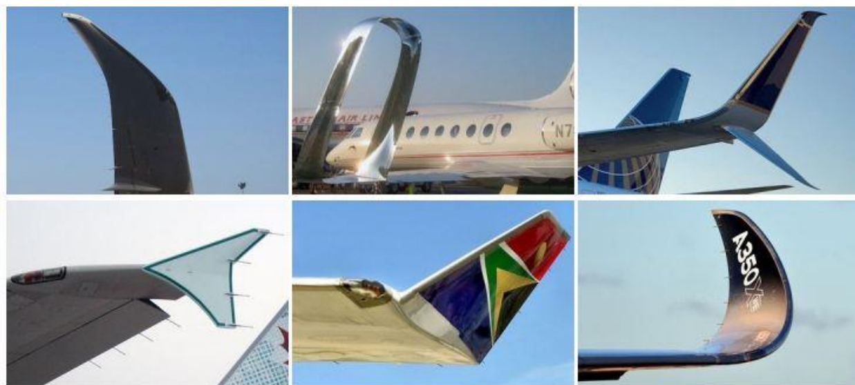
Рисунок 1 – виды законцовок крыла самолёта.
