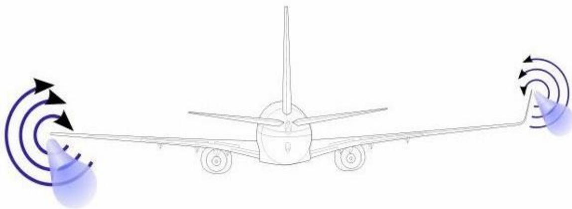
Рисунок 2 – влияние законцовок на уменьшение индуктивного сопротивления.
