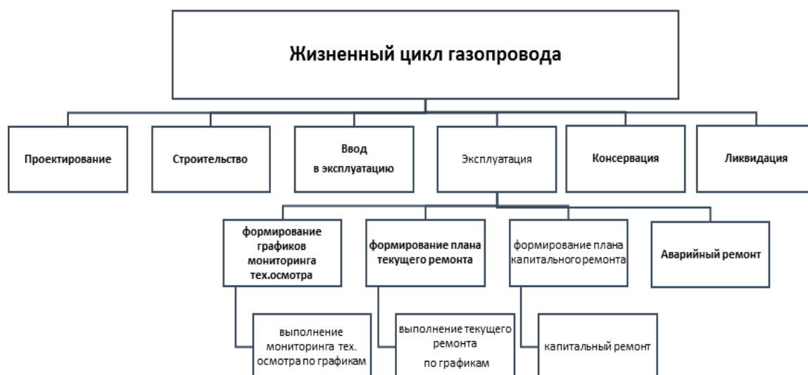
Рисунок 3 – Жизненный цикл газопровода
