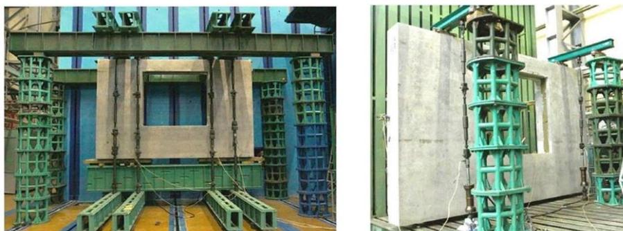
Рисунок 2 – Тестовые модели стеновых панелей
