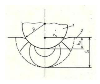
Рисунок 1 – Схема деформирования материала сферическим индентором [7]:
