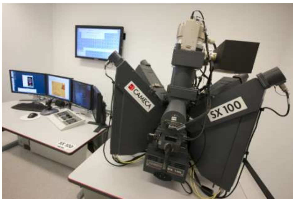
Рисунок 1 - Микроанализатор электронно-зондовый Cameca SX100 SX
