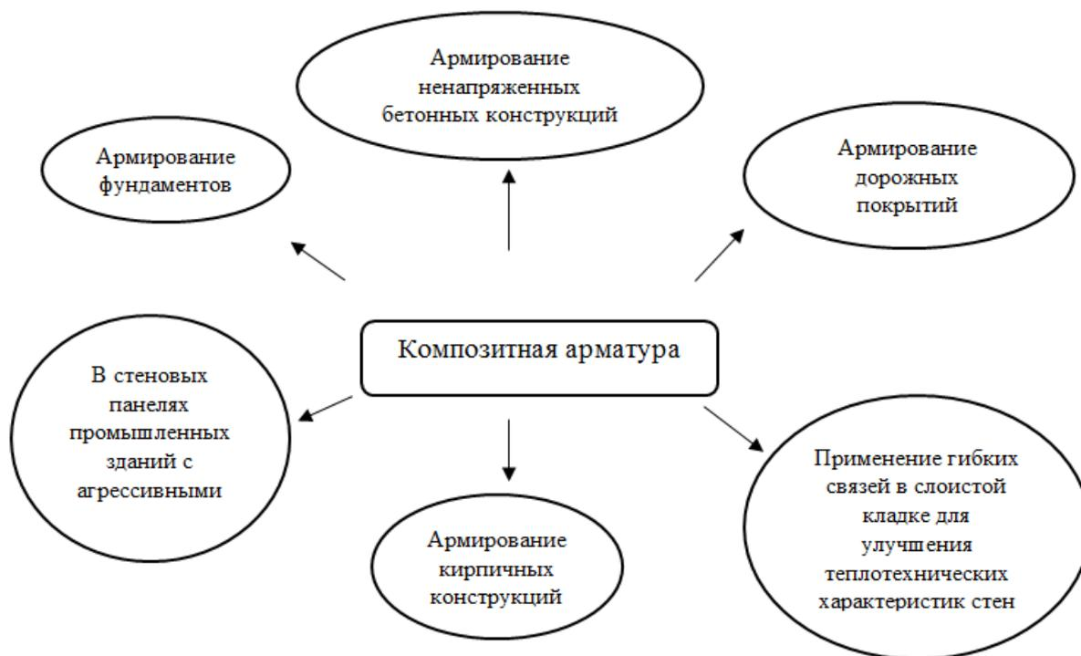
Схема 1-Область применения композитной арматуры.
