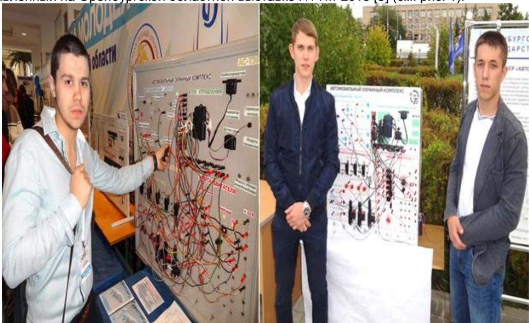
Рисунок 1 – Первый (слева) и второй вариант стенда по обучению сборке схем автосигнализации
