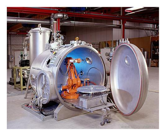
Рисунок 3 – Вакуумная камера для электронно-лучевого покрытия
