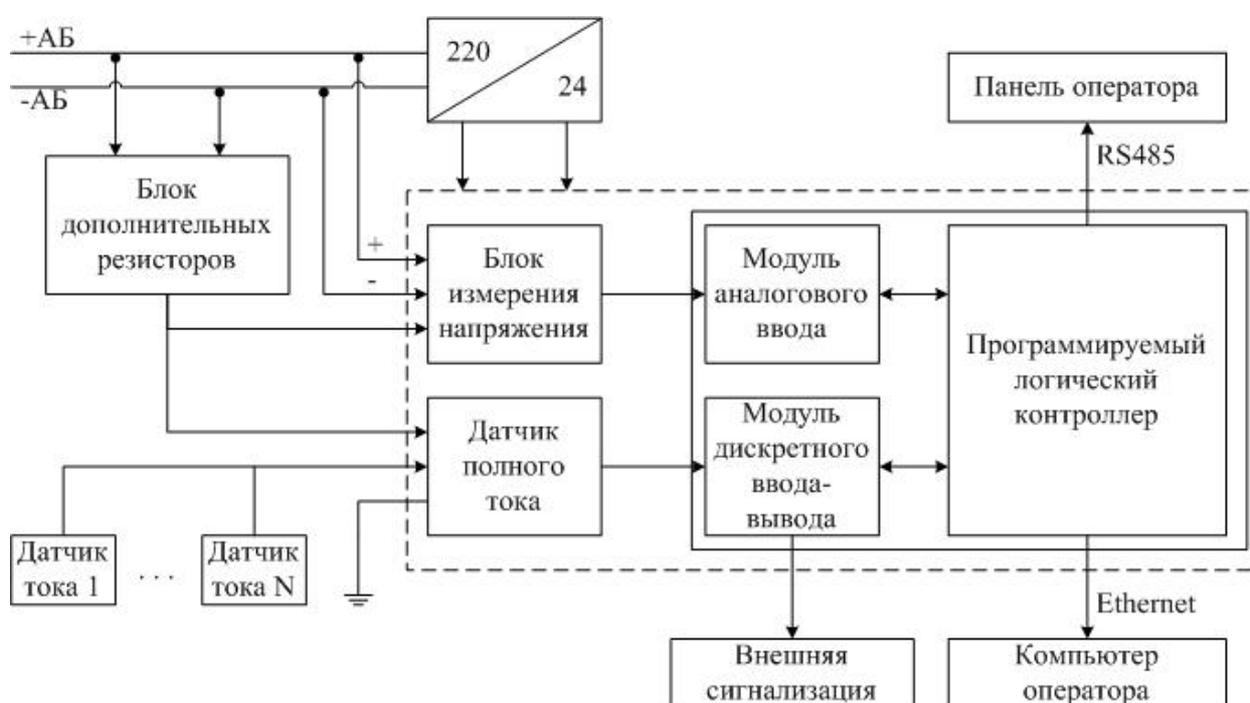
Рисунок 3 – Предлагаемая структурная схема модернизируемой системы контроля изоляции
