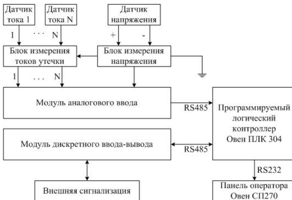
Рисунок 2 – Структурная схема системы контроля изоляции
