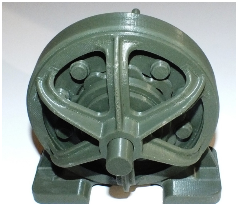
Рисунок 2 – Прототип редуктора (пластик ABS Plus)
