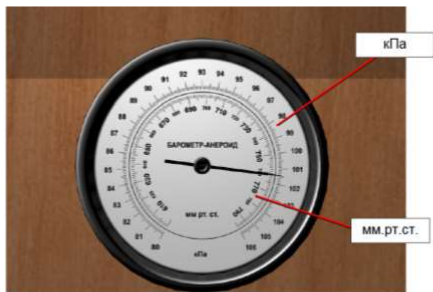
Рисунок 3 – Снятие показаний с барометра-анероида
