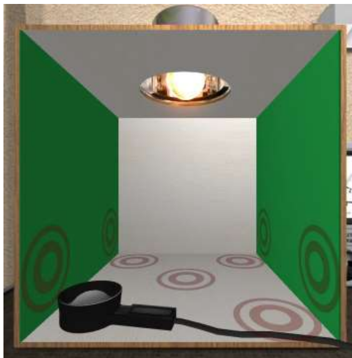
Рисунок 25 – Точки замеров внутри испытательной камеры
