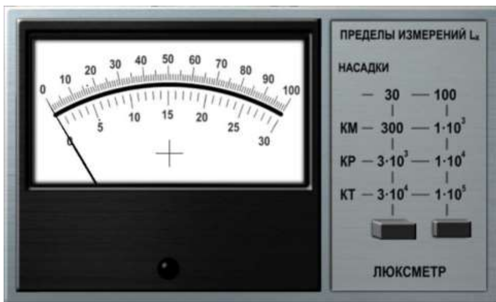
Рисунок 26 – Имитационная модель измерителя люксметра
