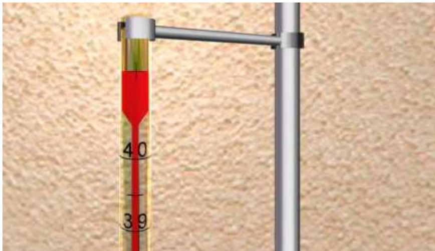
Рисунок 8 – Отметка максимальной температуры нагрева кататермометра
