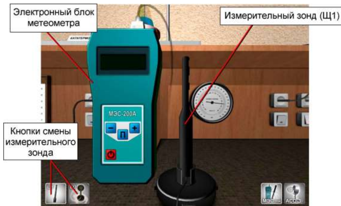
Рисунок 13 – Режим работы с метеометром МЭС-200А (измерительный щуп Щ1)
