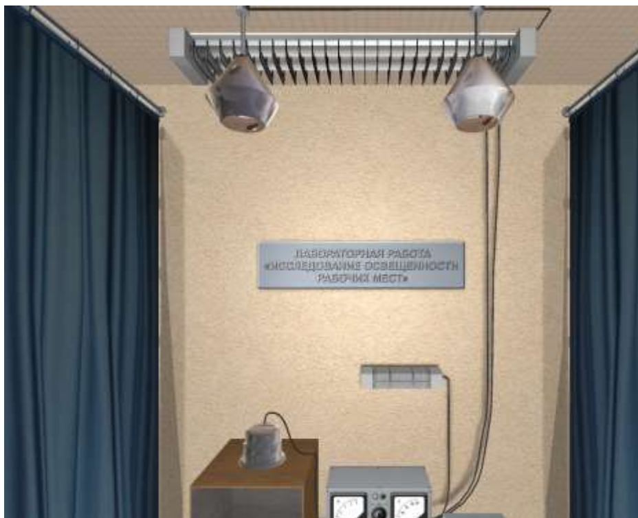
Рисунок 20 – Имитируемая система освещения рабочего места
