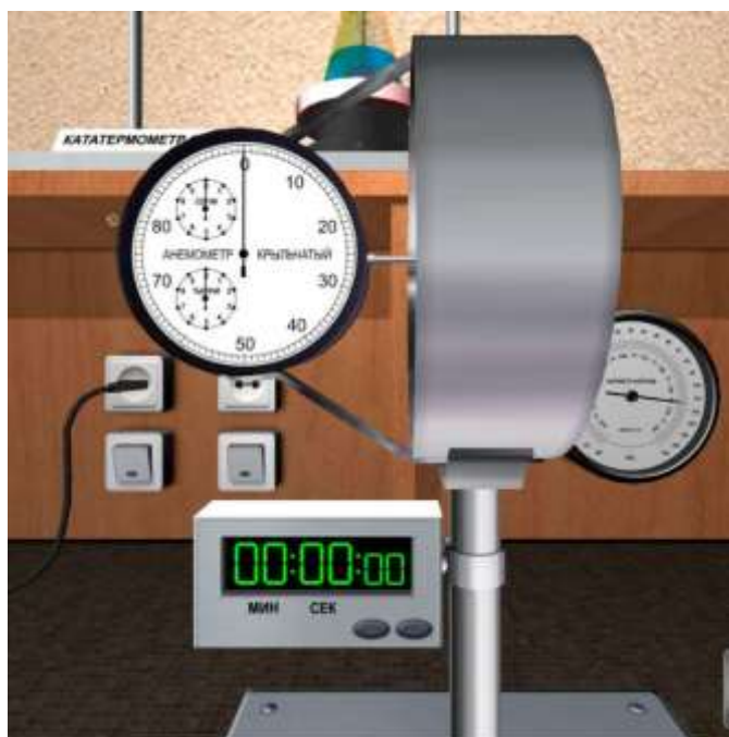
Рисунок 11 – Конструкция крыльчатого анемометра АСО-3
