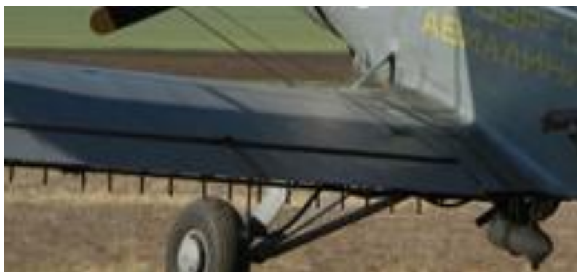
Рисунок 3.1 — Размещение распылительного устройства на крыле СЛА
