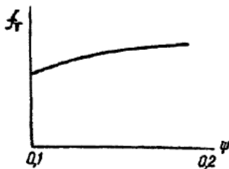
Рисунок 3.7 – Зависимость коэффициента внешнего трения f_T при пластическом насыщенном контакте от параметра \psi при f_{\text{тмол}} = 0,1
