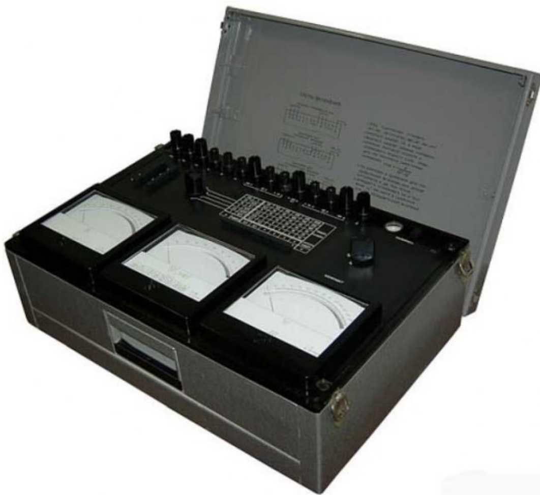
Рисунок 17.3 – Комплект измерительный К505
