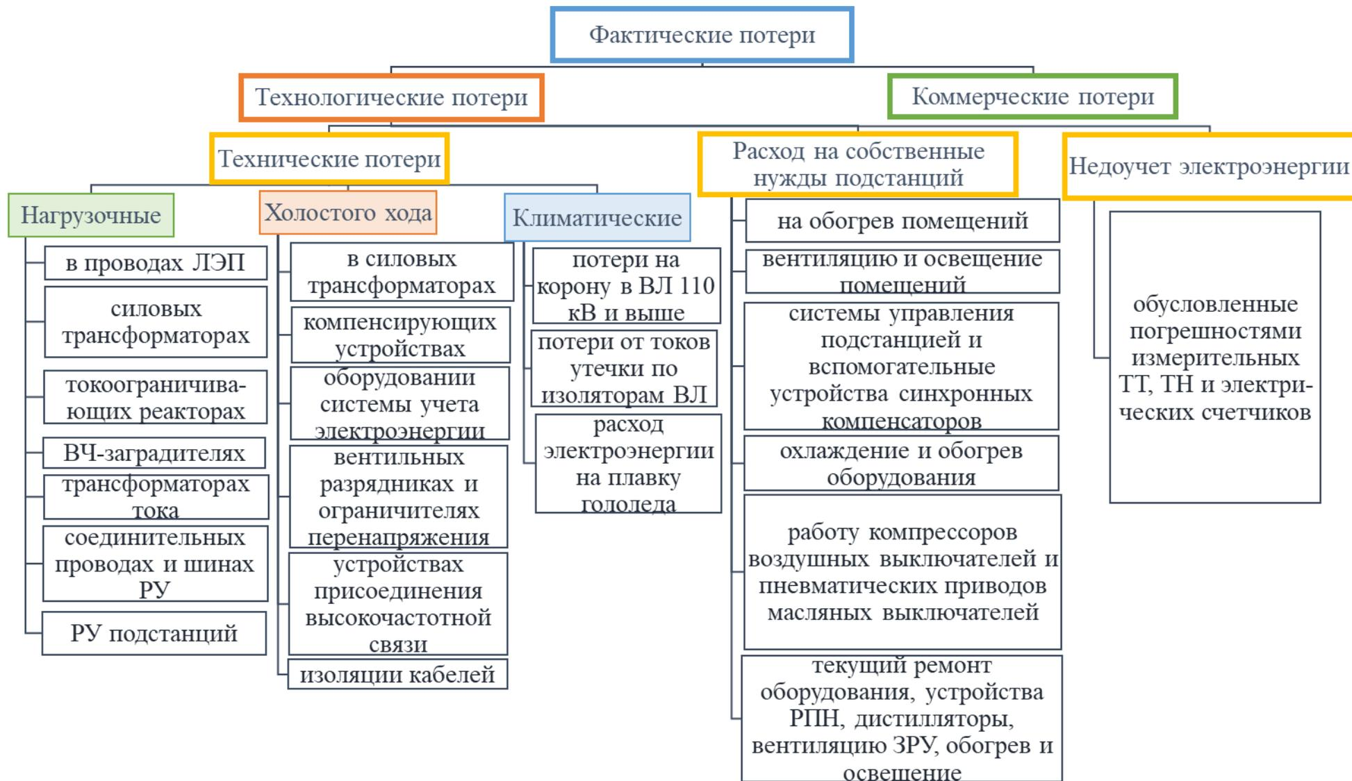
Рисунок 1.1 – Классификация потерь электроэнергии в электрических сетях
