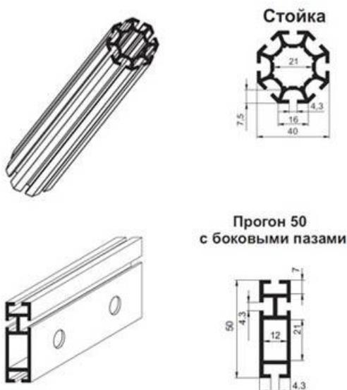
2 Квадратный профиль «Максима» со стороной 40, 80, 120 мм позволяет собирать конструкции высотой в 12 метров и непрерывные прогоны до 6-ти метров. Применяется для строительства уличных сооружений.
