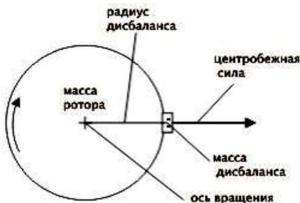
Рисунок 1 – Принципиальная схема неуравновешенности колеса автомобиля
