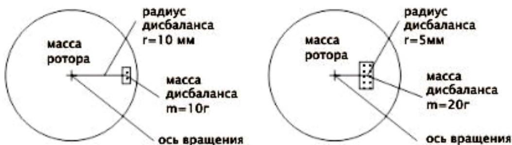
Рисунок 4 – Сравнительная схема измерения дисбаланса колёс
