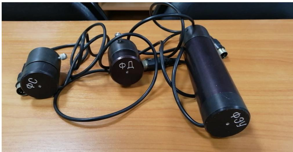
Рисунок 1.11 – Фотосопротивление (ФС), фотодиод (ФД), фотоэлектронный умножитель (ФЭУ)
