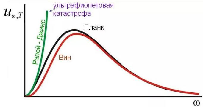
Рисунок 2.3 – Сравнение теорий Рэля-Джинса и Вина с теорией Планка, хорошо согласующейся с экспериментом
