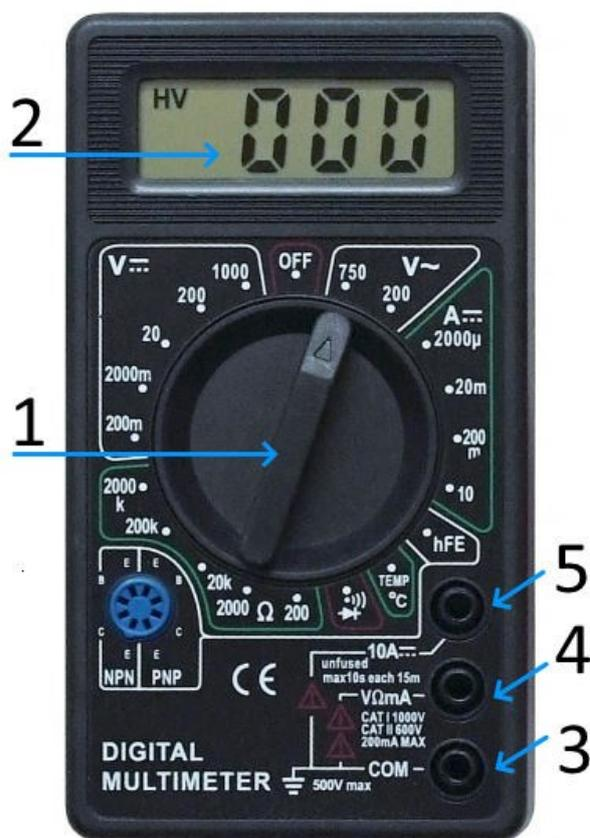
В установке используются мультиметры М830В, DT-830В, или М838 (рисунок П.1). Эти приборы измеряют напряжение, ток, сопротивление, параметры транзисторов и др.
