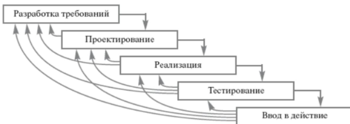
Рисунок 11 – Поэтапная схема разработки ПО
