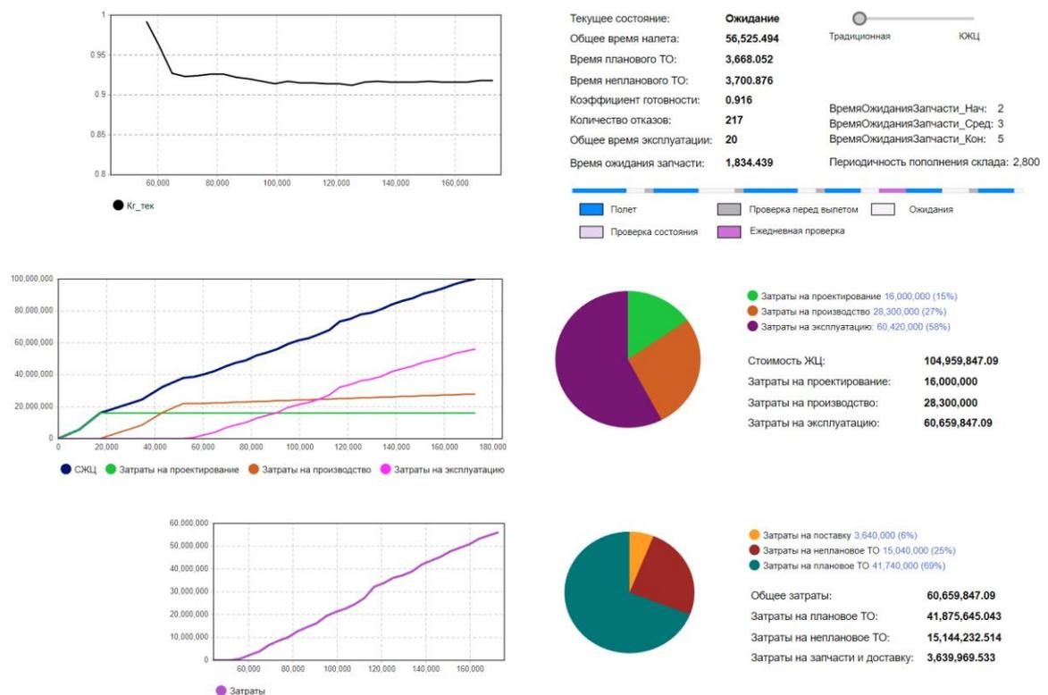
Рисунок Б.3 – Результаты моделирования (тип модели=традиционная; периодичность пополнения склада=2800; время ожидания запчасти=[2;3;5])
