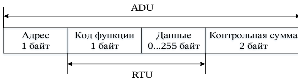
Рисунок В.1 – Формат кадра протокола Modbus RTU
