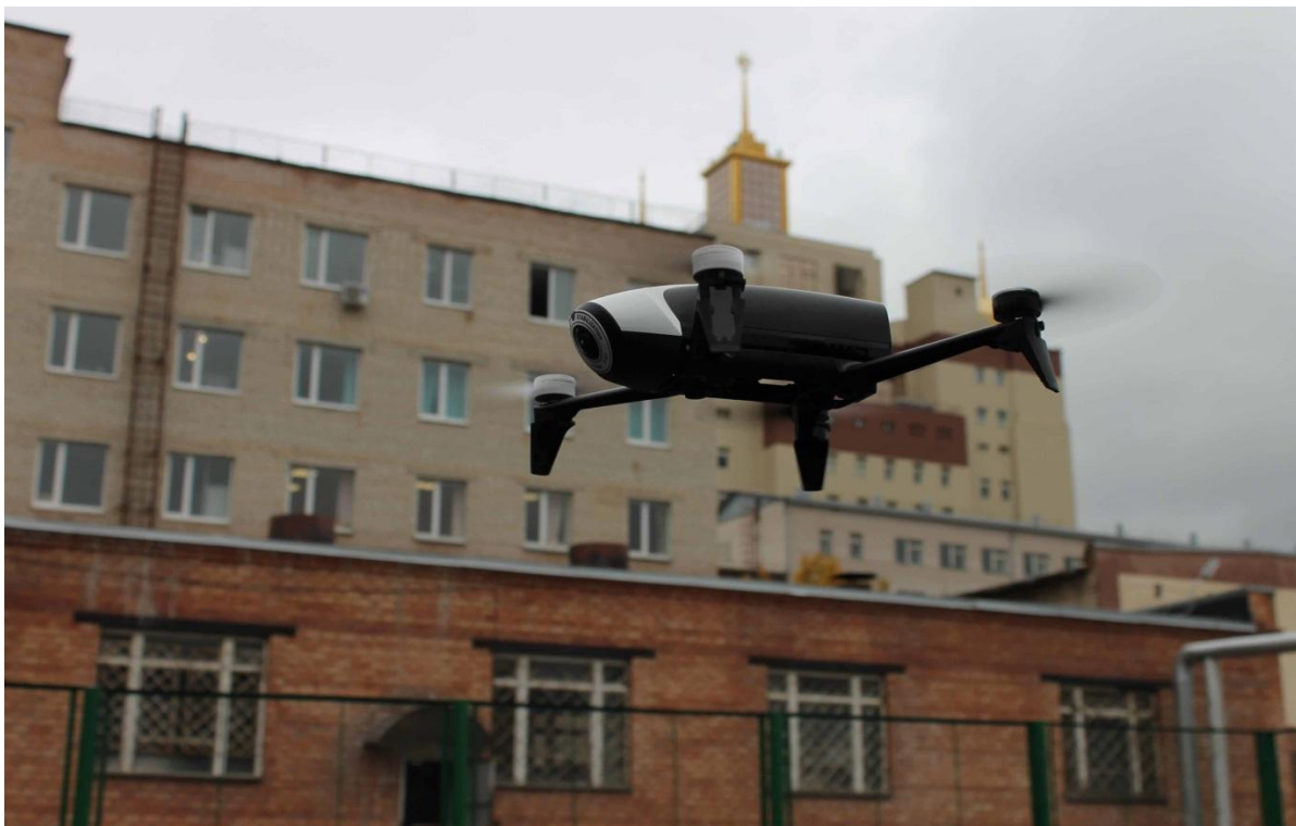
Рисунок Д.9 – Фото мобильного средства видеомониторинга угроз ИБ промышленных объектов (квадрокоптер Parrot Bebop Drone 2)
