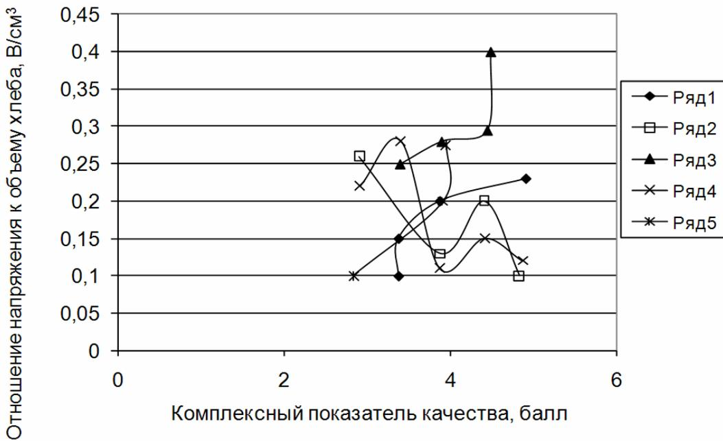
Ряд 1 - ЭК-выпечка(В) при  $M_{\text{соли}}=0,65\%$  и различном напряжении(U); Ряд 2 - ЭКВ при  $M_{\text{соли}}=1,3\%$  и различном U; Ряд 3 - ЭКВ при  $U=380\text{В}$  и различном расстоянии между электродами(A); Ряд 4 - ЭКВ в вакууме при различном A; Ряд 5 - ЭКВ в вакууме при различном U.
