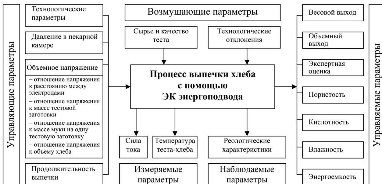
Рисунок 11 – Параметрическая схема процесса ЭК-выпечки хлеба
