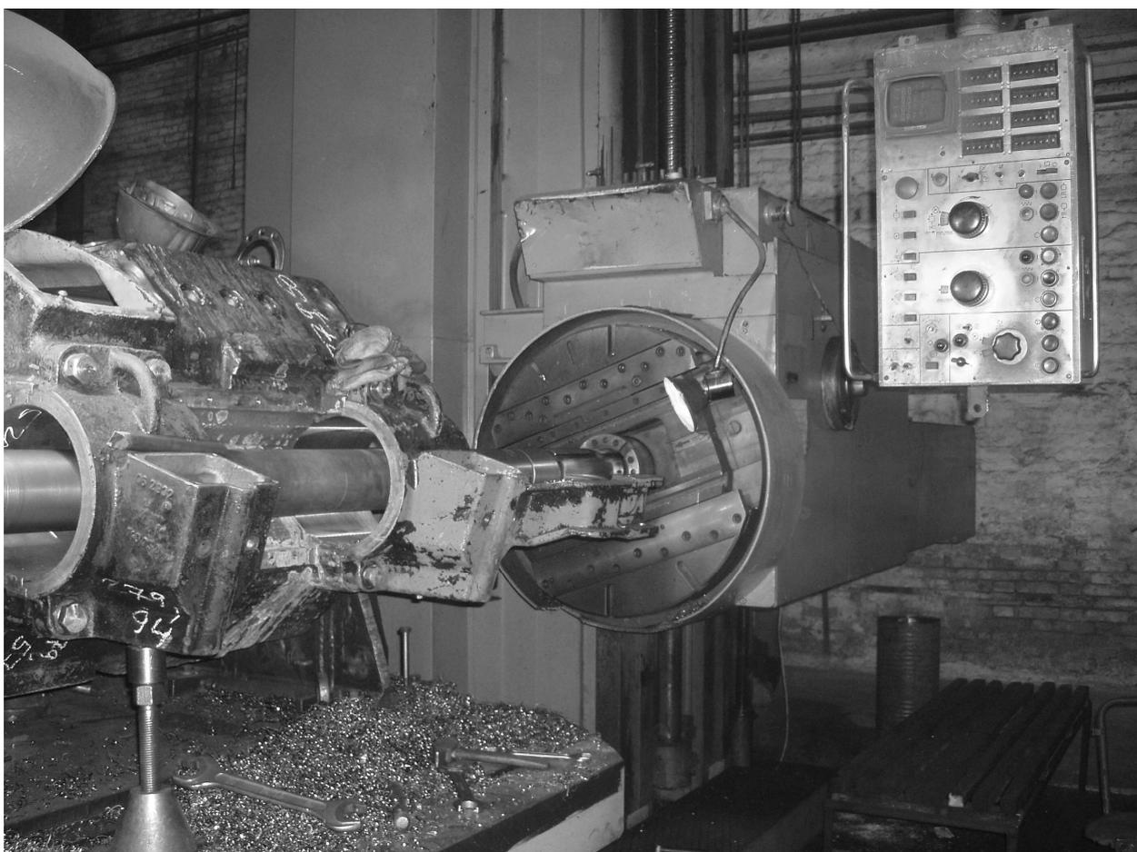
Рисунок 44 – Обработка корпуса тягового двигателя на станке 2А636
