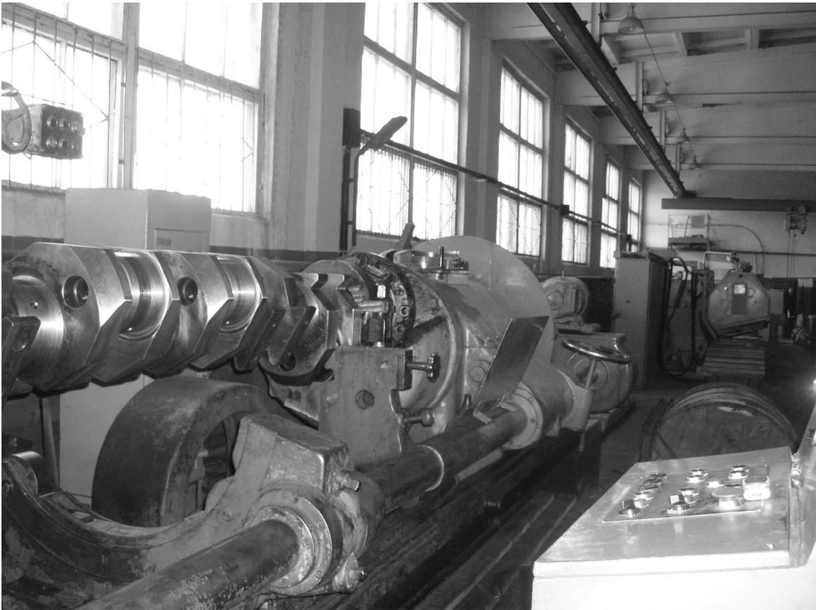
Рисунок 41 – Общий вид станка 3А428
