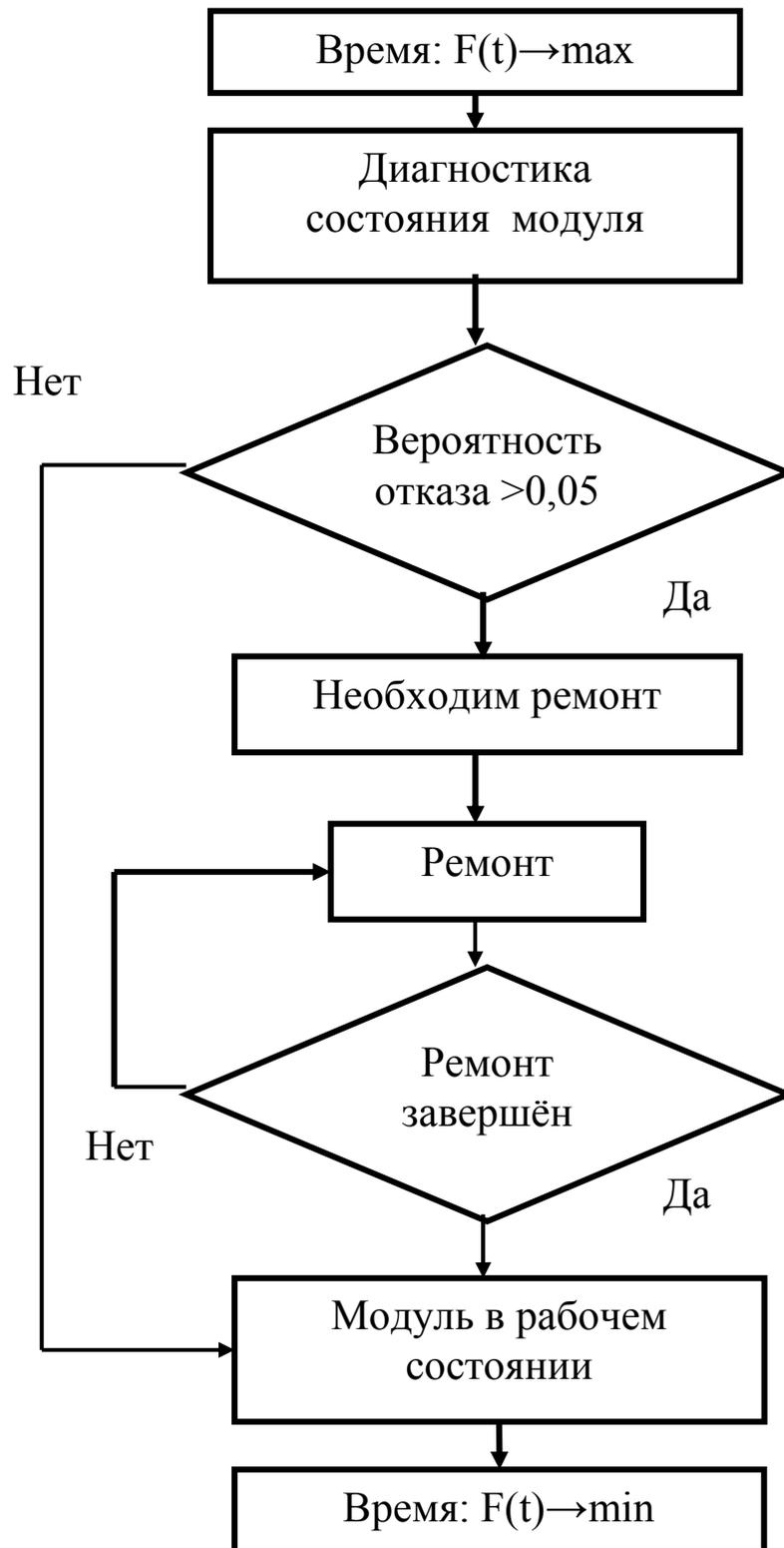
Рисунок 29 – Алгоритм реализации модели упреждающего управления на этапе «диагностика»
