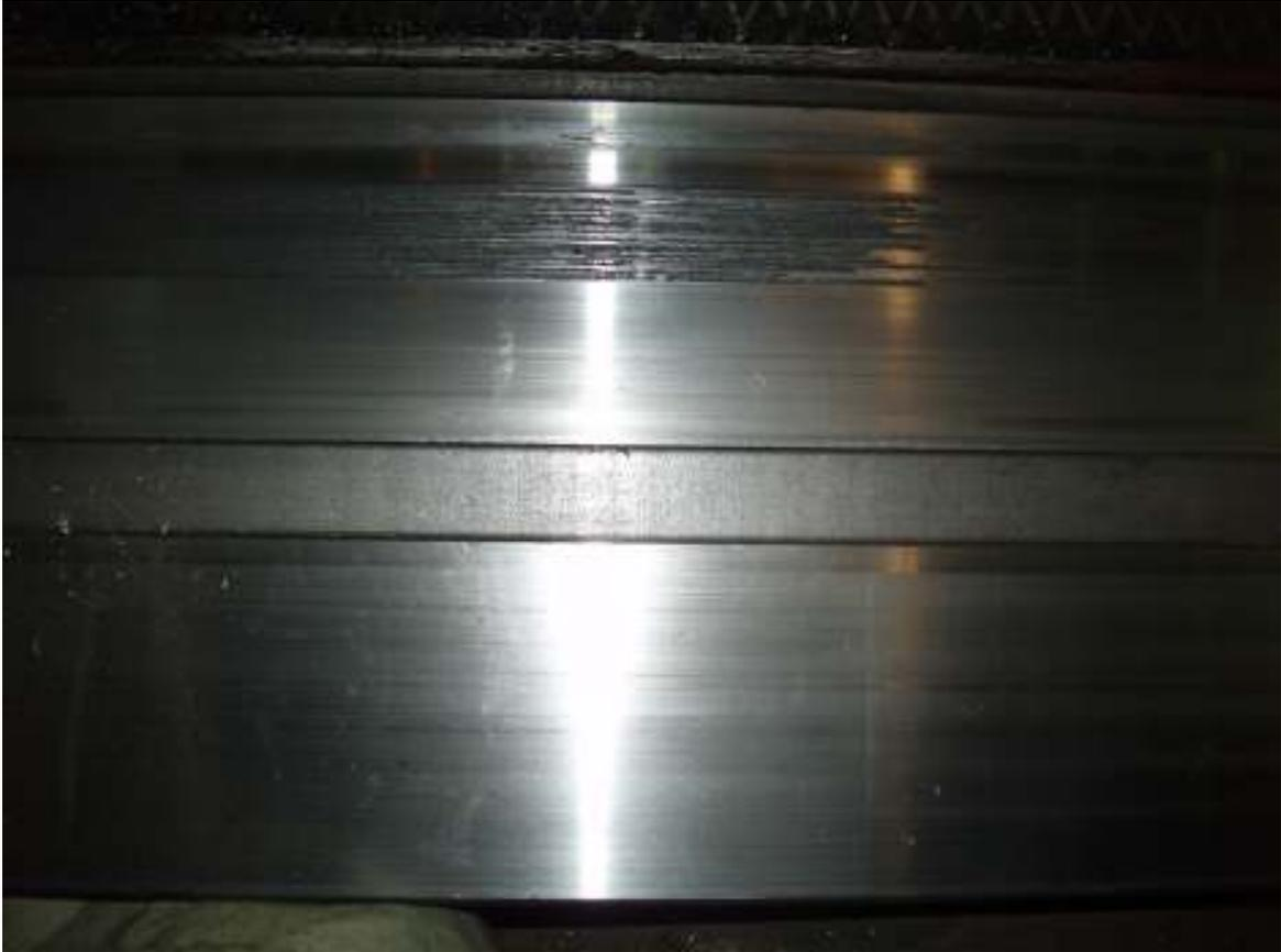
Рисунок 11 – Образование задигов на направляющих
